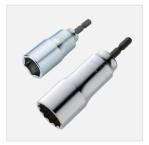
21mm・24mm深型 六角コーチボルトとアン カーナットは21mmで、 両ネジシャフトは24mm深 型で締めます。
