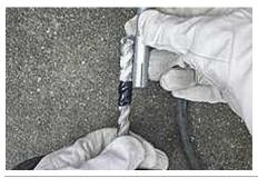
ハンマードリルで穴をあける前に、コンクリート用ドリル刃とピン付きアンカーを並べて、ネジ山の手前までアンカーが刺さるようにドリルの刃先から約5cmのところにビニールテープなどを巻いて目印にします。
